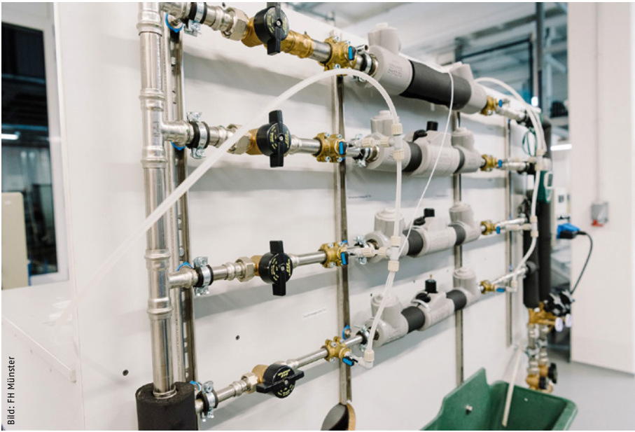
Bild 5: Prüfstand für thermostatische Zirkulationsventile an der FH Münster – Fachbereich EGU.
