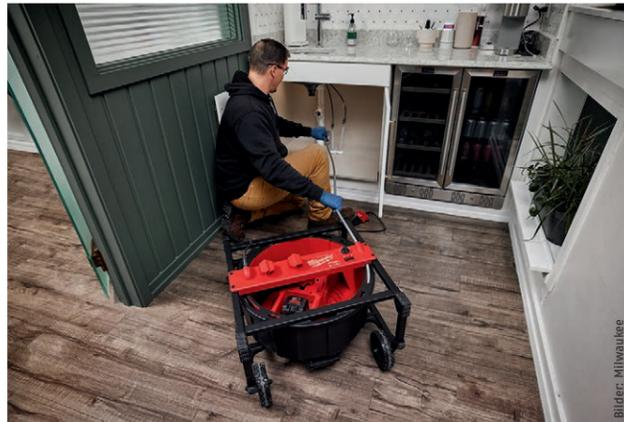
Die Akku-Rohrreinigungsmaschine „M18 HSFSM“ hat einen bürstenlosen Motor, der mit M18 Lithium-Ionen-Akkus arbeitet. Ihre Kapazität liegt bei 12 Ah, die Milwaukee in eine Laufzeit von bis zu 60 Minuten umrechnet.
