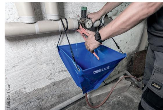
Für Arbeiten über Boden bzw. über Kopf gibt es einen Trichter, der aufgehängt werden kann und so ein freihändiges Arbeiten bei z. B. Rohrbrüchen, Leckagen oder Pumpentausch ermöglichen. Über einen 3/4-Zoll-Anschluss kann ein Schlauch angeschlossen und die Flüssigkeit abgeleitet werden. Den Trichter gibt es mit den Kantenlängen 40 x 40 cm und 80 x 80 cm (Bild). Der kleine Trichter fasst 25 Liter, der große 50 Liter.
