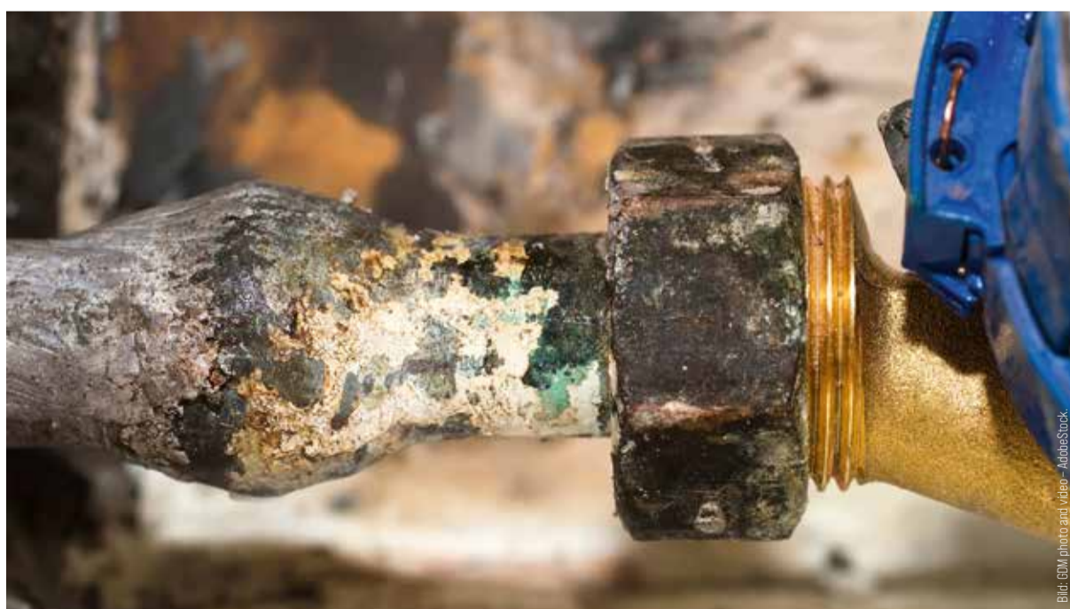
Trinkwasserleitungen aus Blei müssen entfernt und stillgelegt werden. Dazu gehört auch die Anzeigepflicht.
