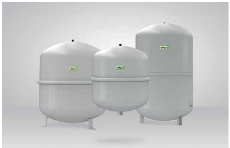
Abbildung 1: Statische Membran-Druckausdehnungsgefäße können neben ihrer Grundfunktion auch als Steuer- oder Puffergefäß eingesetzt werden.
