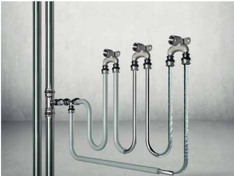
Abbildung 6: Die technische Sanierung einer kontaminierten Trinkwasserinstallation ist die einzige nachhaltige Maßnahme der Ursachenbekämpfung – beispielsweise die Installation von Reihen- (PWH, PWC) und Ringleitungen (nur PWC), um das Stagnationsrisiko deutlich zu verringern.
