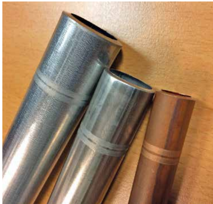
Abbildung 2: Die Markierungen sind auf verzinkten Rohren, auf Edelstahl- und auf Kupferrohren gut sichtbar und können eindeutig den Schneidegeräten zugeordnet werden.
