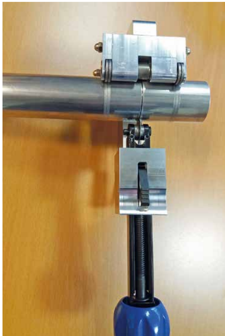
Abbildung 3: Das Versuchswerkzeug hinterlässt auf beiden Seiten der Schnittkante eine gut sichtbare Markierung.
