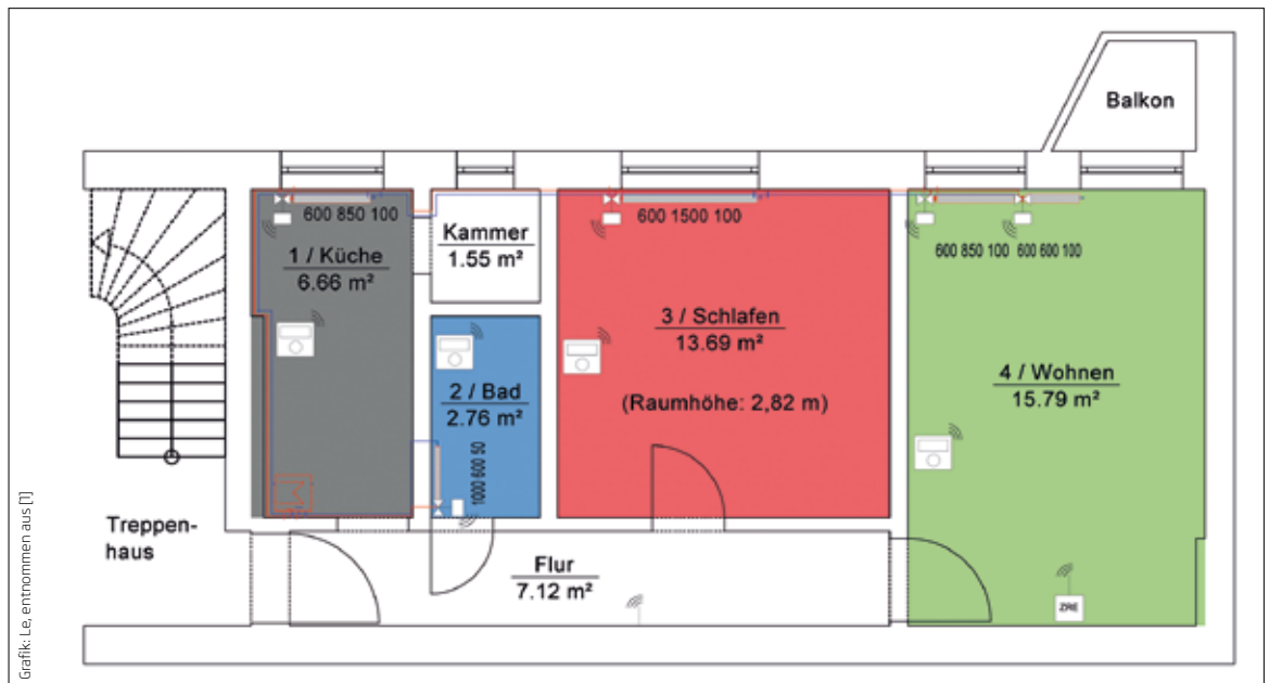
Abbildung 6: Grundriss der Feldanlage 2 mit vier beheizten Wohnräumen
